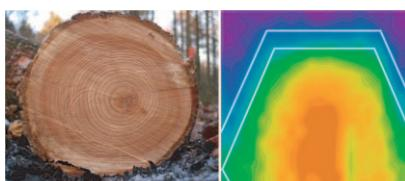
**Wie Baumringe zählen:** Ein neue Strategie zur Untersuchung von Kristallwachstumsprozessen beruht auf der retrospektiven Analyse fertiger Kristalle. Die Zusammensetzung der wachsenden Kristalloberflächen variiert während des Kristallwachstums, während die Kristallstruktur unverändert bleibt, und die Zusammensetzungsverteilung im Kristall wird durch konfokale Raman-Mikrospektrometrie erfasst (siehe Bild).
